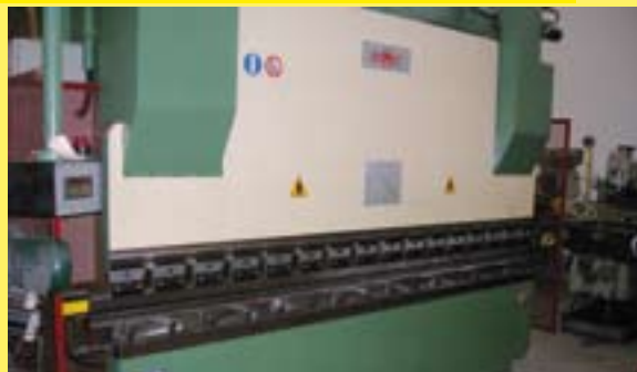
Pressopiegatrice Romec Mod. HP170, 3.000 mm x 170 ton Completa di registro motorizzato euro 37.000,00
